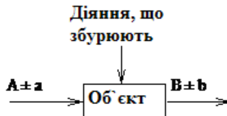
Рис.6.1. Структурна схема об'єкта при наявності факторів, що збурюють
